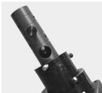
Collimateur Cheshire installé sur le porte-oculaire. Le point rouge décentré indique une mauvaise collimation
