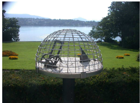
Le canon de midi fonctionne avec une loupe qui, judicieusement positionnée, concentre les rayons du soleil sur le canon de manière à faire la mise à feu au passage du midi vrai.
