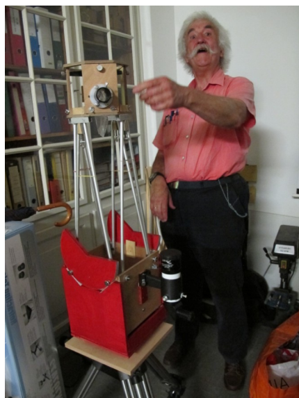
Marc Dumas exhibe fièrement son Dobson 150 mm dont il a échangé le miroir pour la plus petite focale de 750 mm.
