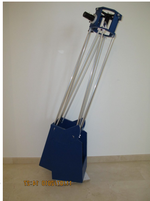
Après le réhaussement de la boîte du primaire et le rocker, mon Dobson réhaussé est tout à fait équilibré dans toutes les positions et est prêt à l'emploi
