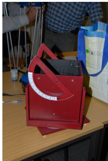
Pour l'orientation azimutale, le rocker tourne sur son axe. La rotation est amortie par des petits patins en téflon.
