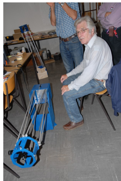
Fixation des tubes sur la cage du secondaire d'un 150 au moyen de bécottes assurant une bonne rigidité de l'ensemble.
