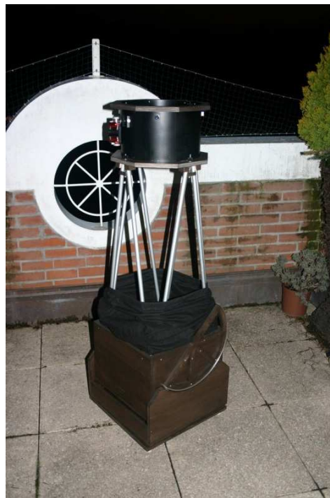
Dobson 250 mm de Yann modifié en type Serrurier
